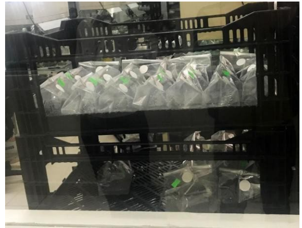
ถุงพลาสติกที่บรรจุอาหารเลี้ยงเชื้อ หลังจากผ่านกระบวนการฆ่าเชื้อด้วยไอน้ำ
